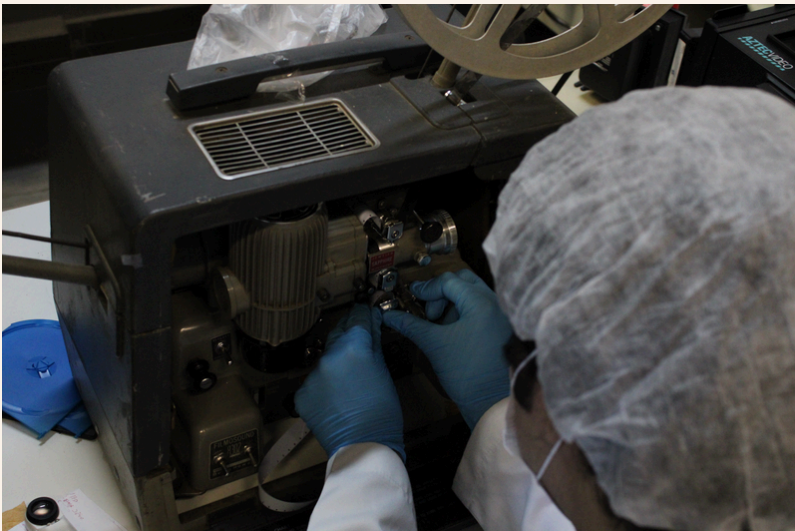
Figura XV - Processo de montagem do filme no projetor II
