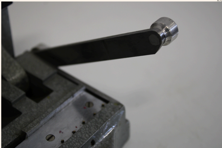
Figura VI - Guilhotina da coladeira 16mm, utilizada para cortar o filme de forma limpa e precisa.
