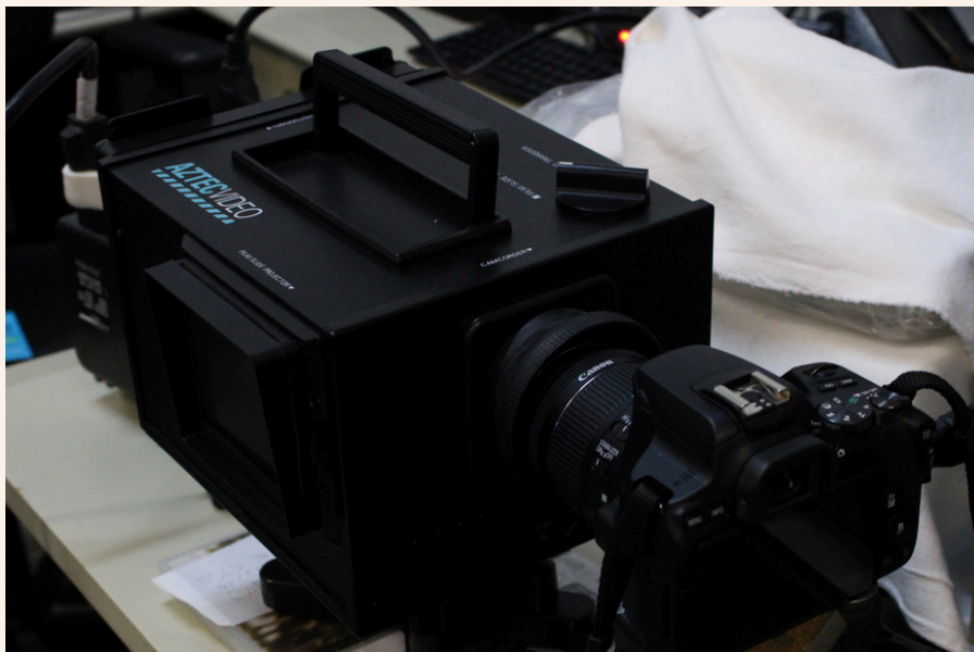
Figura XIX - Caixa de telecinagem com câmera posicionada na saída da imagem.
