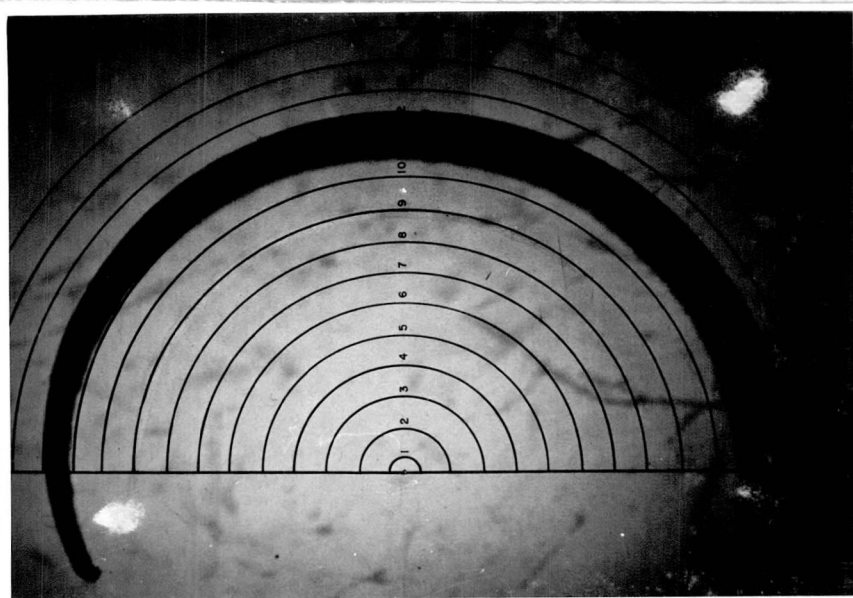
Figura 22 - Medição da curvatura do cavaco no projetor de perfil com o auxílio de curvas de diâmetro co hencido.
