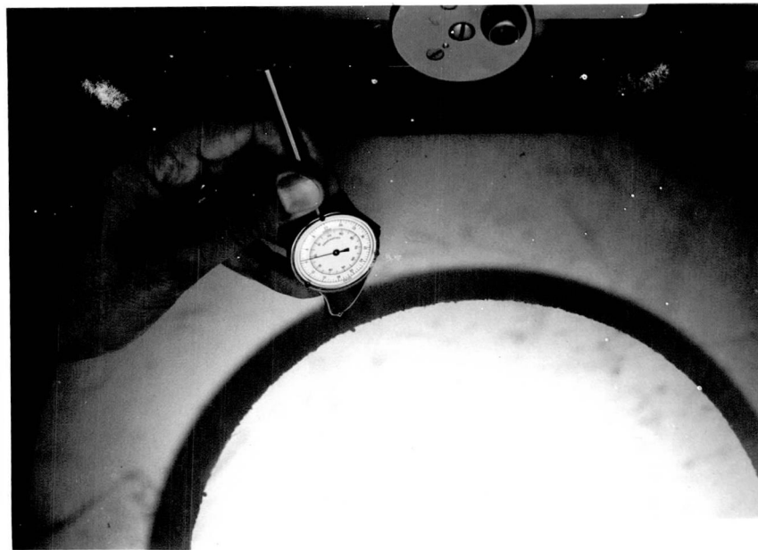
Figura 21 - Medição dos comprimentos do cavaco no projetor de perfil com auxílio de um curvímeter.
