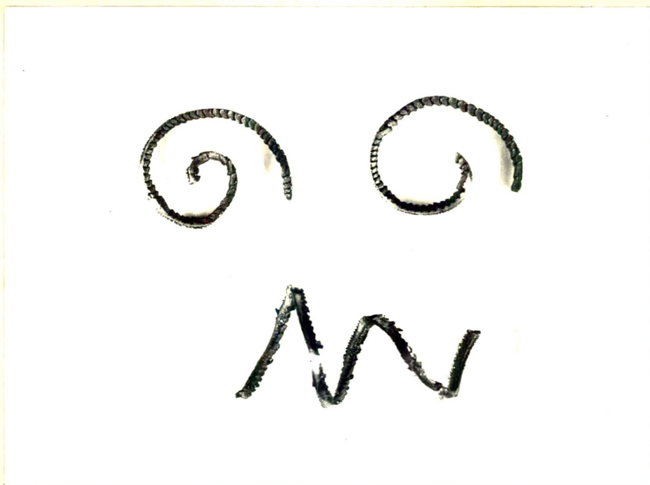
Fig. 50 - Aspecto dos cavacos retirados nos ensaios do método 1.
