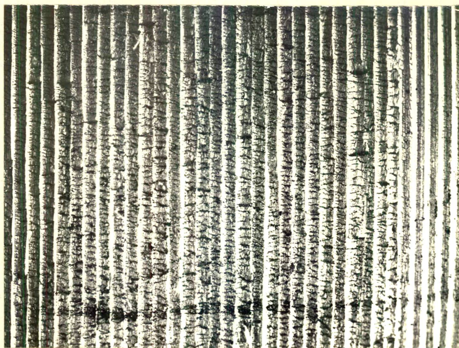
Fig. 51 - Aspecto da superfície usinada dos anéis de ensaio.
