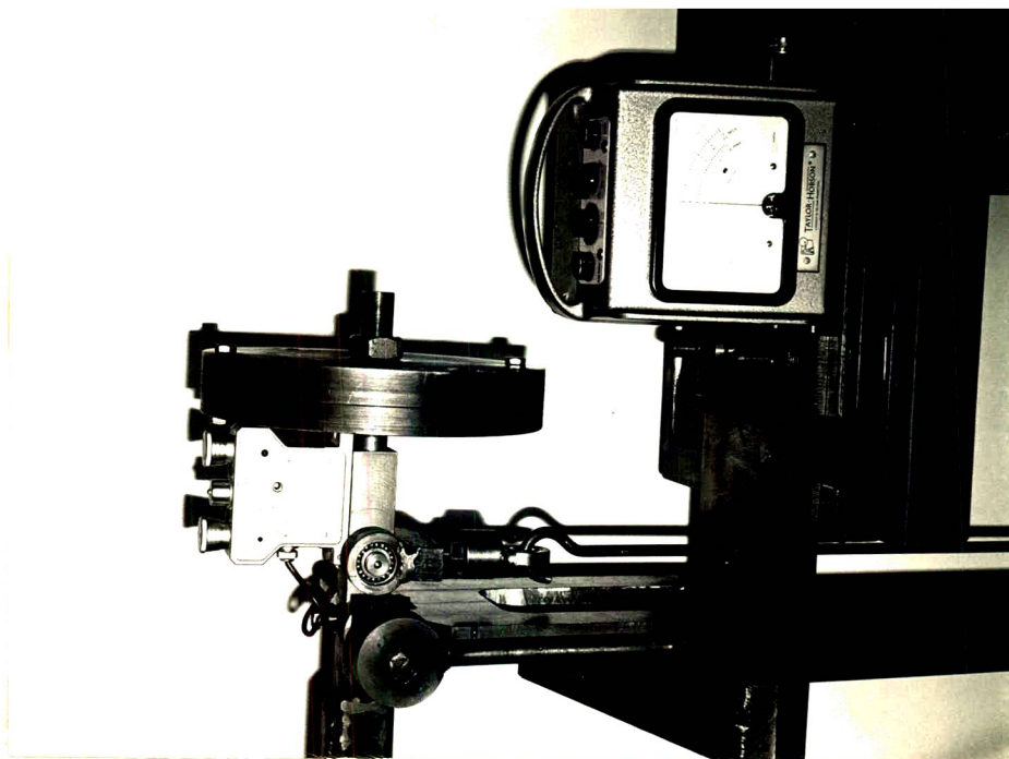
Fig. 29 - Detalhe da aferição da balança dinamométrica mecânica através de nível eletrônico.
