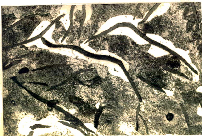
Fig. 4.6 - Amostra do corpo de prova 5 X250 - Atacado com Nital
