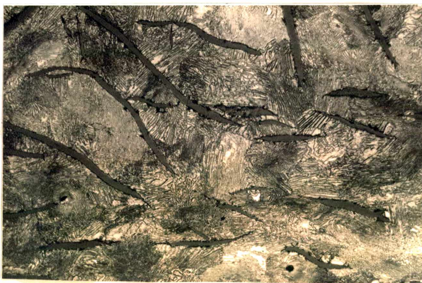
Fig. 4.8 - Amostra do anel nº 2 X250 - Atacado com Nital
