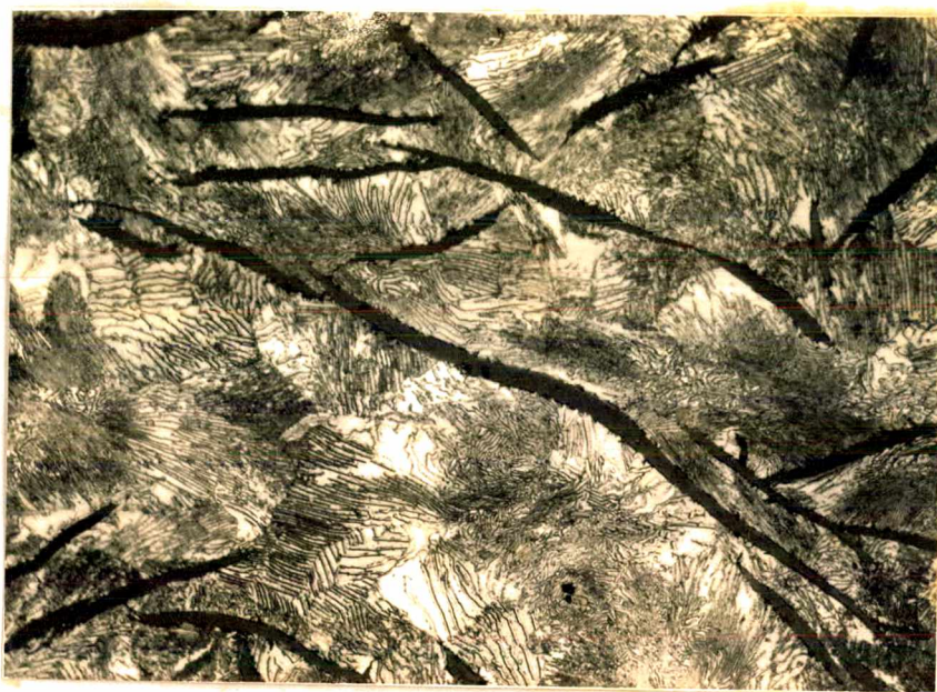
Fig. 4.11 - Amostra do anel 5 X250 - Atacado com Nital
