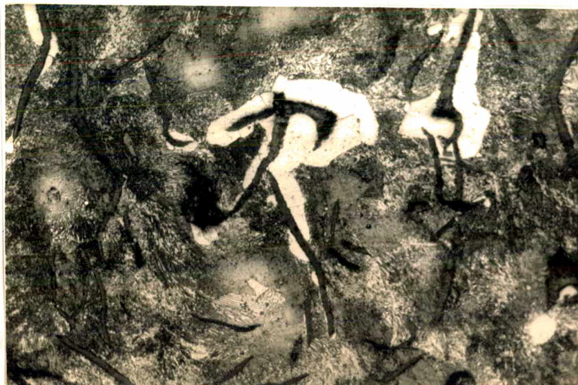
Fig. 4.5 - Amostra do corpo de prova 3 X250 - Atacado com Nital.
