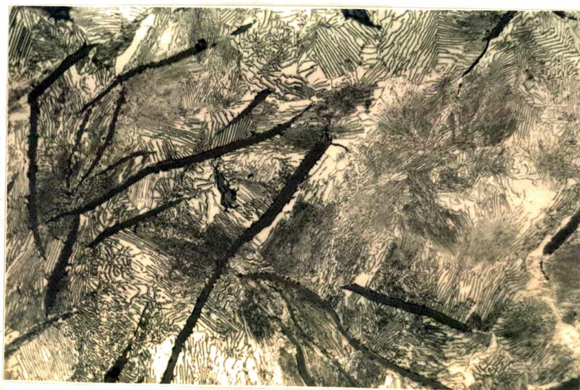
Fig. 4.10 - Amostra do anel 4 X250 - Atacado com Nital
