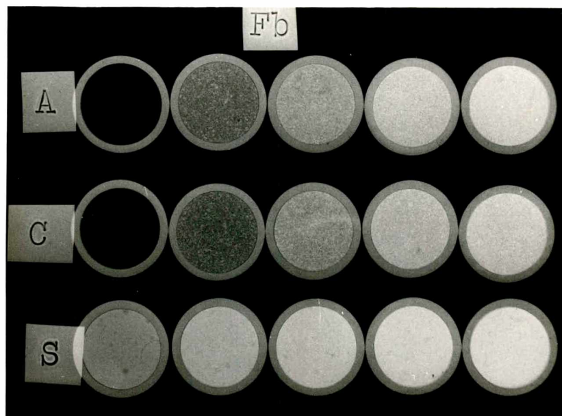
Fig. 4-4: Radiografia dos c.p. das 3 resinas compostas com acrêscimos de proporções de 0, 10, 20, 30 e 40% de fluoreto de bário, onde se observa o a crêscimo de radiopacidade com o crescer das proporções de aditivo.
