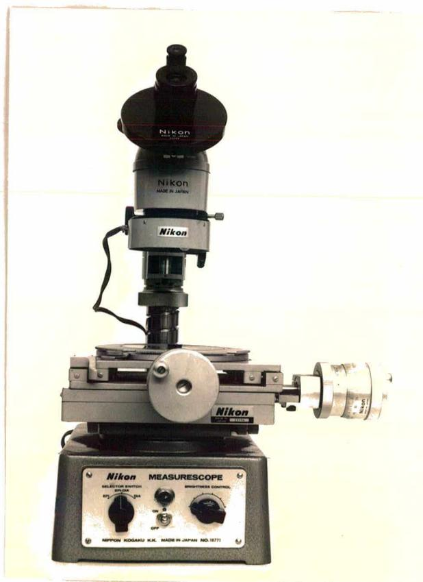
Fig. 22 - Microscópio de ferramentaria usado para a medição do desgaste de flanco e largura da cratera.
