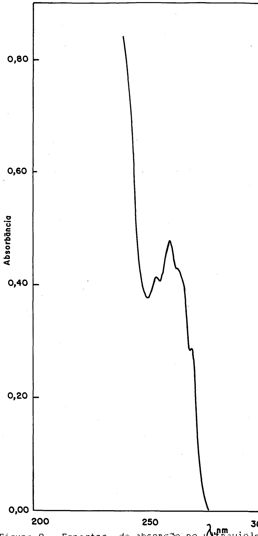
Figura 8 - Espectro de absorção no ultravioleta do IDTH em metanol, a uma concentração 1,20 \times 10^{-3} \text{ M} a 25^\circ \text{C} .
