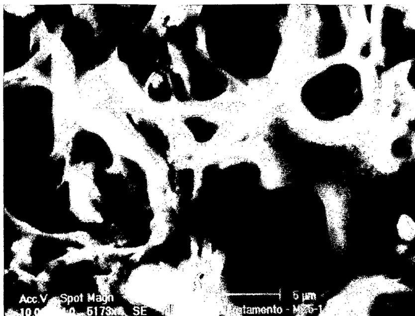
FIGURA 14 (b) - Ampliação de 5.173 vezes do núcleo da microcápsula.
