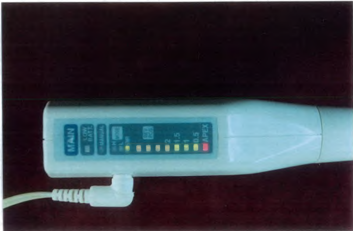
FIGURA 5: Painel de controle do aparelho Tri Auto ZX indicando que o nível “apex” foi alcançado pela ponta da lima.
