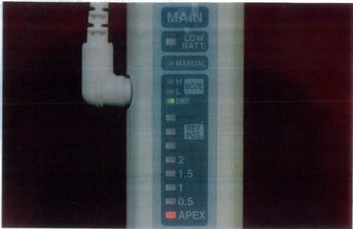
FIGURA 3: Painel de controle do aparelho Tri Auto ZX ajustado para localizar o forame apical.
