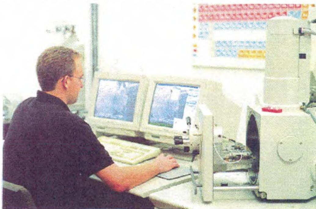
**FIGURA 18:** Microscópio eletrônico de varredura marca PHILLIPS modelo XL 30 acoplado a microsonda de Raios X EDAX.
