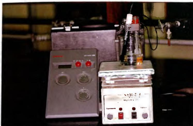
**FIGURA 7:** *Potenciômetro marca CORING modelo 220 com eletrodo íon-seletivo para flúor.*
