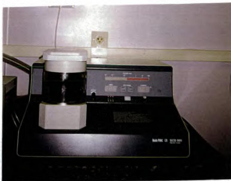
**FIGURA 17:** Metalizador marca BAL-TEC modelo SCD.
