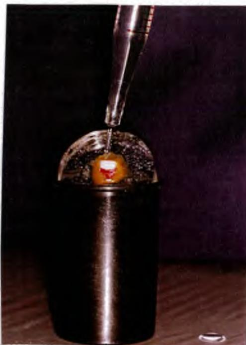
*FIGURA 19: Procedimento prévio para a análise química quantitativa: Lavagem dos blocos de esmalte com a solução de ácido nítrico  $10^{-2}M$ .*
