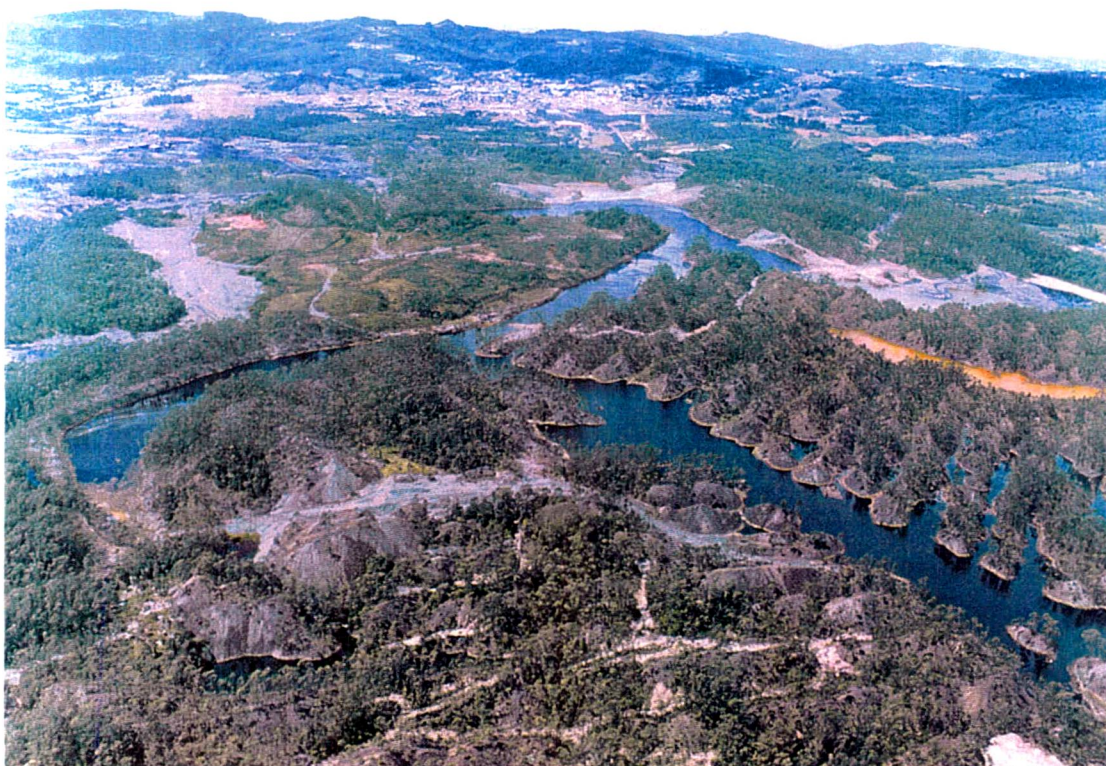
Figura 22: A foto inclui a mesma área da figura 21. Constata-se a presença de vegetação espontânea, cobrindo as pilhas de estéreis da mineração a céu aberto. Foto: agosto de 2000, cedida pela Companhia Carbonífera Rio Deserto.
