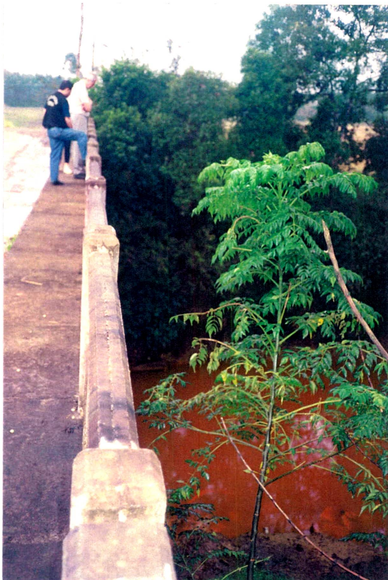
Figura 39: Estação de monitoramento no rio Sangão, AML5. A coloração vermelha das águas reflete a elevada concentração de ferro associada aos baixos valores de pH e concentração de oxigênio dissolvido, o que faz com que o metal na forma predominantemente reduzida permaneça dissolvido na água. Presença também de outros contaminantes característicos das atividades ligadas a exploração do carvão e outras atividades industriais já que nesse ponto o rio reúne os afluentes que atravessam o município de Criciúma.
