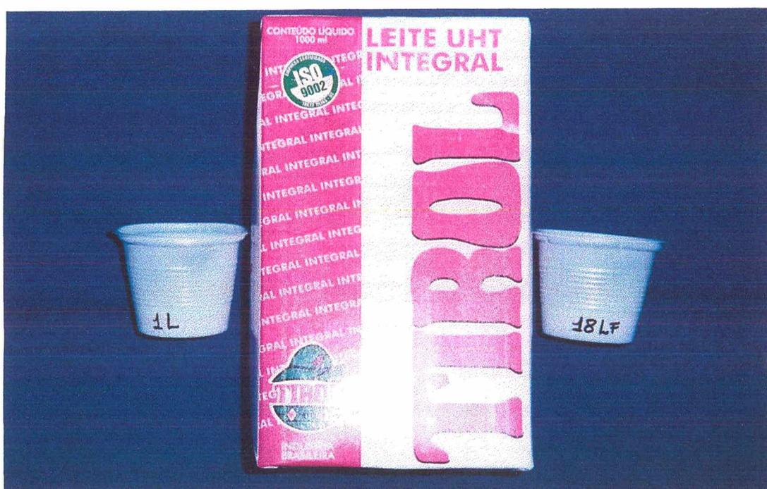
No leite LF adicionou-se a quantidade total de 801,7mg (miligramas) de fluoreto, na forma de fluoreto de potássio [KF], pesada em balança analítica Sartorius modelo EA 620, a qual correspondeu a uma concentração aproximada de 2mg de fluoreto de potássio por ml de leite (2000 ppm).
