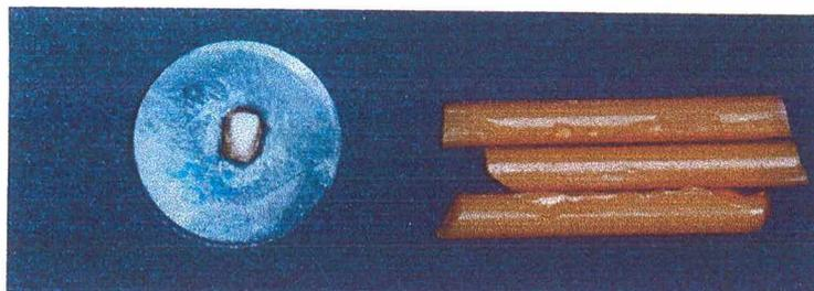
As superfícies de esmalte (cl clinicamente sadias) foram levemente polidas em lixadeira mecânica do Laboratório de Materiais do Curso de Engenharia Mecânica da UFSC, com o emprego de discos de lixa d'água de n.600 e n.1200 (3M), com a finalidade de facilitar a delimitação da área de teste.
