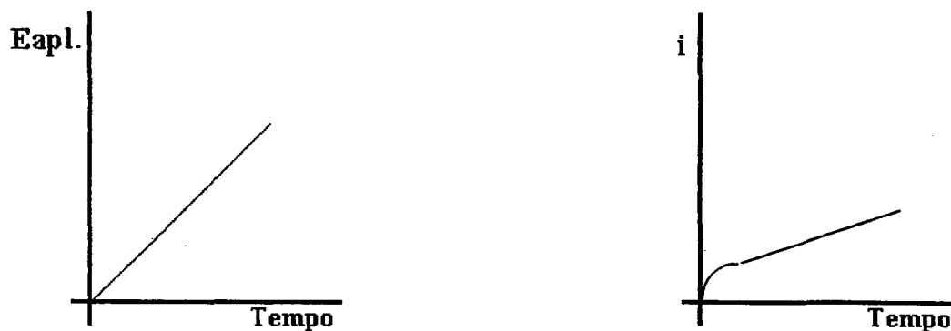
Figura 8. Correntes não-faradaicas a potencial variado.
