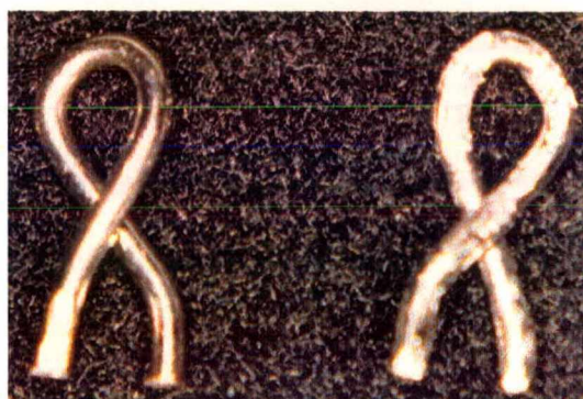
Figura 4 – Pinos de fio ortodôntico 0.6mm na forma da letra grega “gama” antes e depois da asperização.
