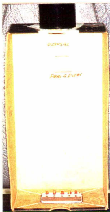
Figura 2 – Película posicionada no dispositivo utilizado para padronização das radiografias.
