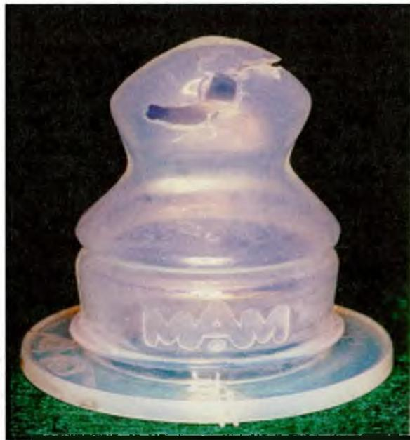
**Figura 6:** Bico rasgado (vista frontal).
