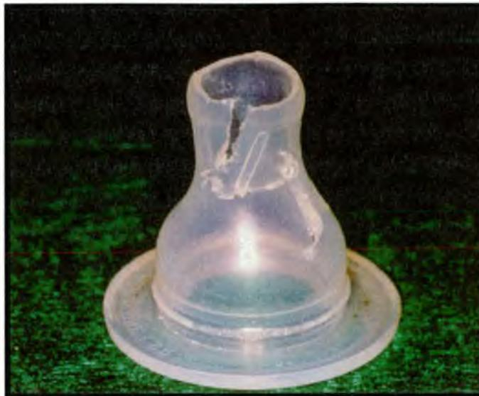
**Figura 4:** Bico com a extremidade seccionada (vista frontal)
