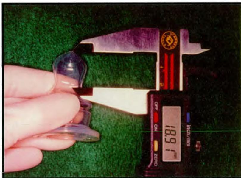
Figura 1: Medição do comprimento dos bicos com auxílio do paquímetro digital.
