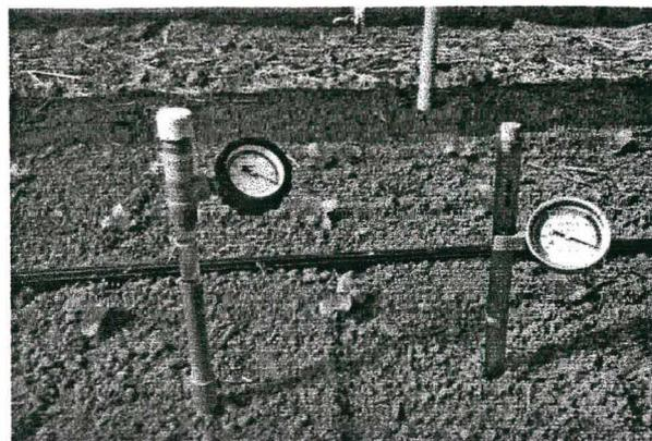
FIGURA 19 – Tensiômetro de solo instalado nos canteiros.
