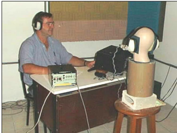
**Foto** de medição com dois microfones no manequim, dentro da câmara do LARI
