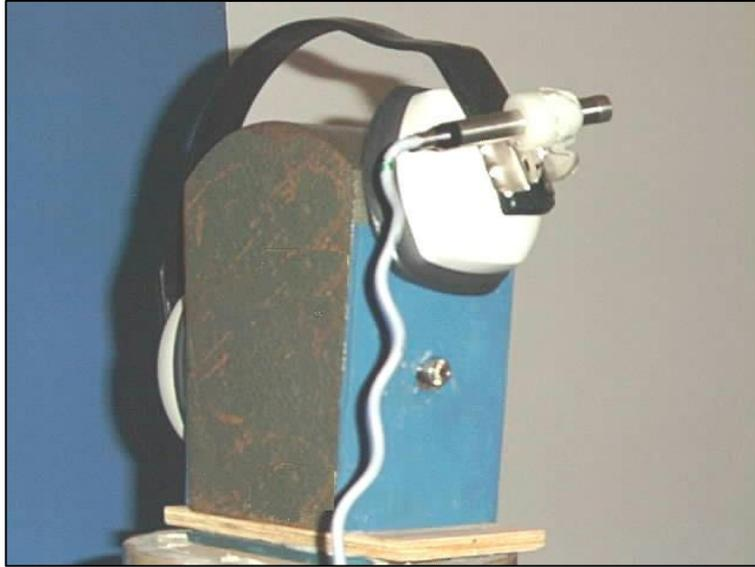
de 70 dB, os níveis de pressão sonora medidos no microfone externo (fixado na haste da concha) chegam próximos a 54 dB em 1000 Hz.
