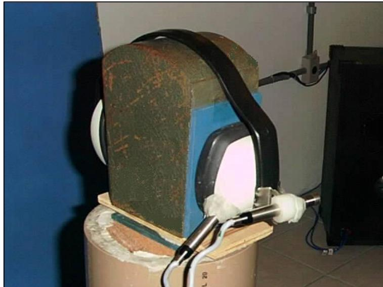
TABELA 7.1: Atenuação do protetor auditivo, em cabeça artificial de *ferro fundido* com microfones B&K no *furo da cabeça* e fora para níveis de 60-70-80-90 e 100 dB.
