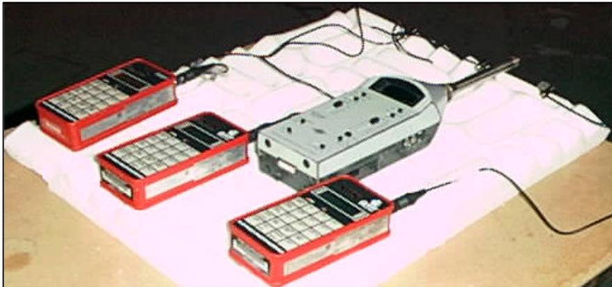
Dosímetros e medido do nível de pressão sonora, e os microfones na mesma distancia da fonte, dentro da câmara semi-aneecóica do LVA.
