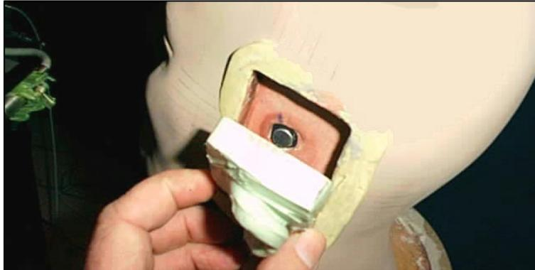
TABELA 7.3: Atenuação do protetor auditivo, em cabeça artificial do manequim com microfones B&K no furo da cabeça e fora, para níveis de 60-70-80-90 e 100 dB.
