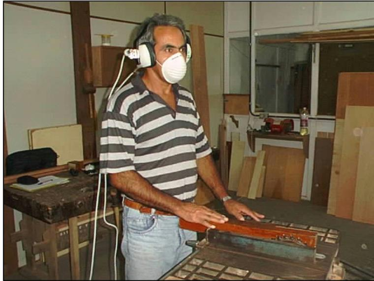
procedimentos e cada uma realizou o processo de corte da madeira quando foram medidos simultaneamente os níveis de ruído dentro e fora da concha do protetor auditivo.
