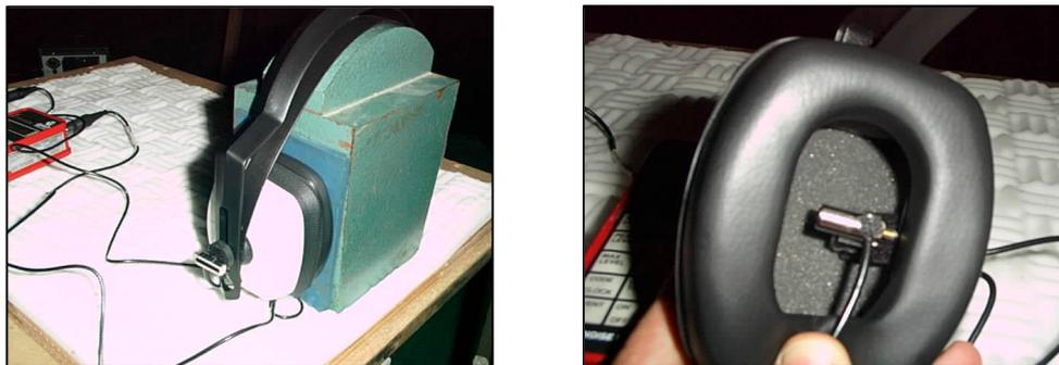
TABELA 6.3: Dados de  $L_{eq}$  em (dBA) obtidos nos dosímetros NPS2 e NPS1, para dois modelos de protetores auditivos tipo concha, em função da mudança da direção do microfone instalado dentro da concha.
