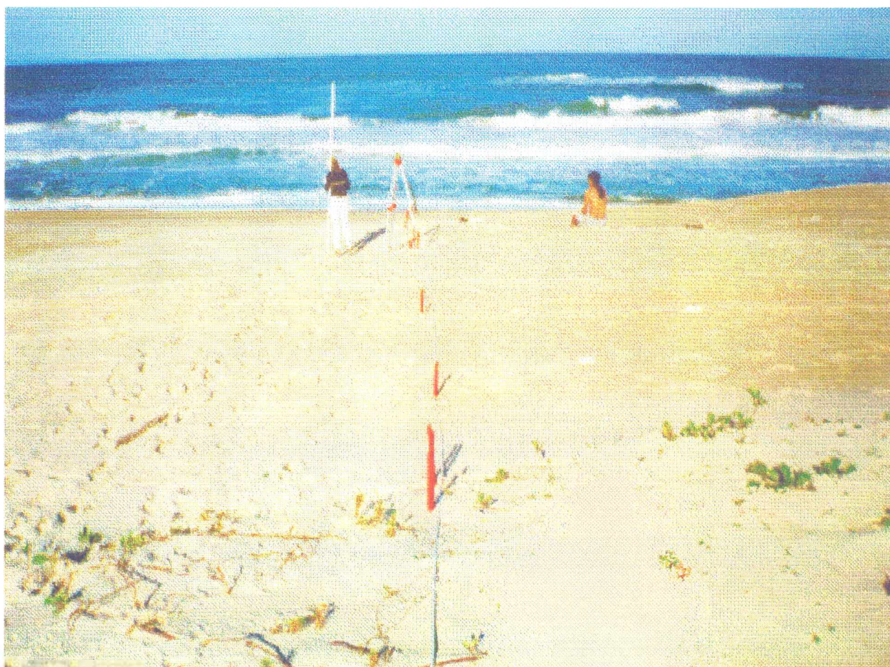
Foto 03 – Nivelamento topográfico com a utilização de nível, mira e trena.
