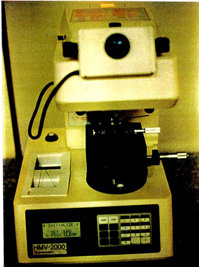
**Figura 3:** Aparelho do tipo microdurômetro SHIMADZU HMV 2000 (Shimadzu Co., Japan), com corpo de prova sendo analisado (seta).
