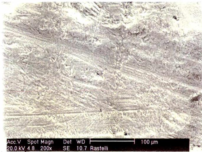
**Figura 12:** Fotomicrografia da amostra 3B2 (área experimental – diaminofluoreto de prata a 30% por 2 minutos), sem alteração morfológica (aumento de 200x).
