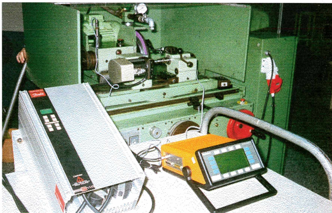
Figura 48 - Conversor de frequência Danfoss modelo VLT 2050 e aparelho de medição da velocidade angular Schenck, modelo VB 41, na calibração da velocidade angular do rebolo [2]
