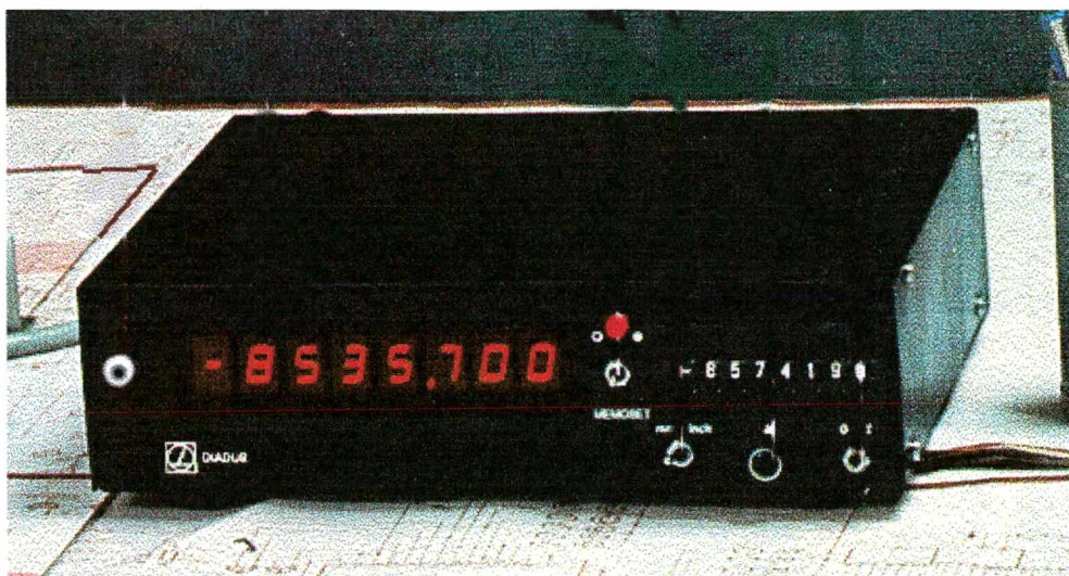
Figura 33 - Painel frontal do mostrador de deslocamento da régua ótica [28]
