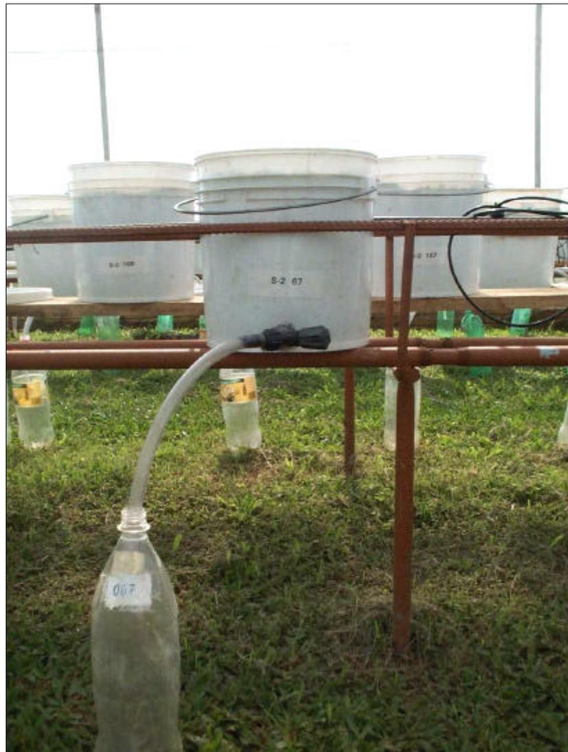
**Figura 6.3.** Ilustração de uma unidade experimental disposta sobre bancada de ferro e com sistema coletor de águas percoladas.
