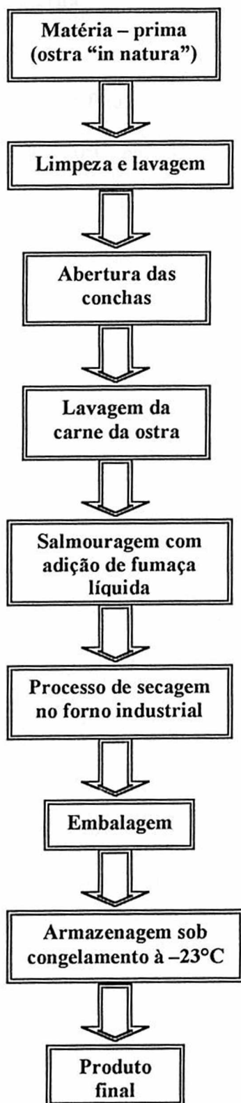
FIGURA 3 - Fluxograma do processo de defumação líquida da ostra ( Crassostrea gigas )
