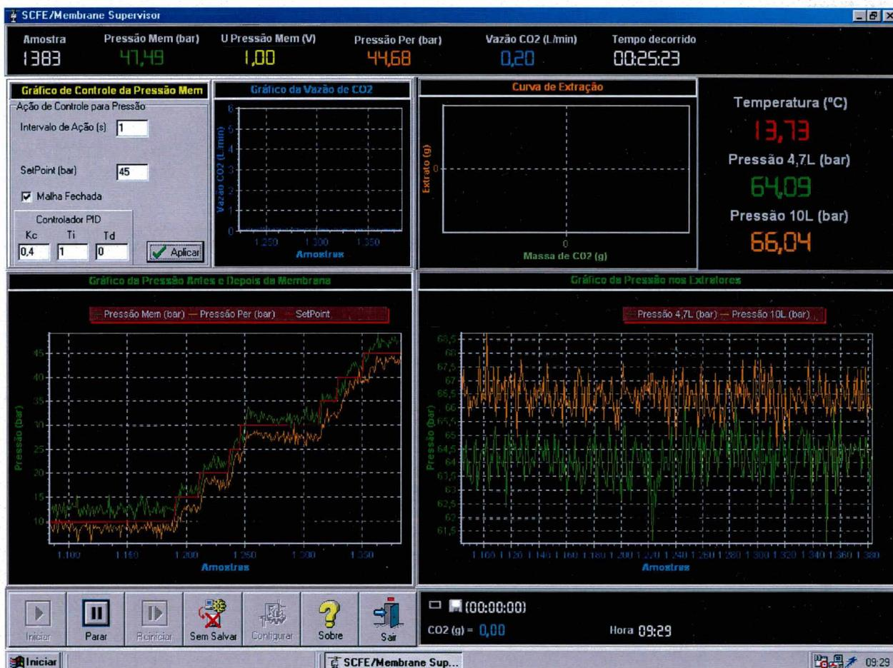
Figura 08. Tela principal do software de monitoramento e controle dos processos de extração e separação.
