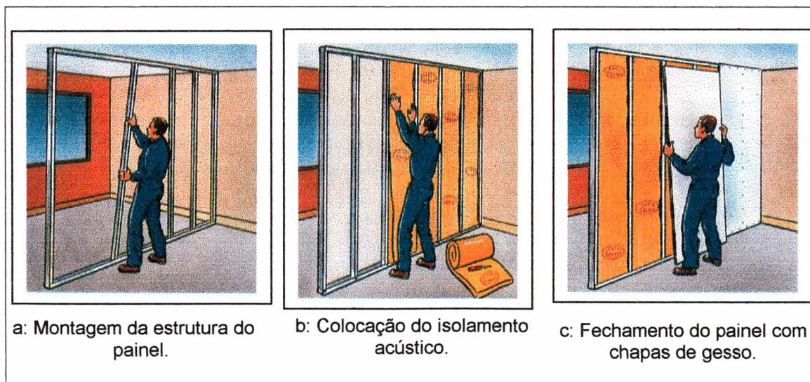
Figura 44: Seqüência de montagem de uma parede interna de gesso acartonado construída no sistema Plataforma. Fonte: ISOLVER (2000, pg. 4).
