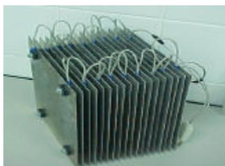
Figura 09 – Foto da Colméia de eletrodos em Alumínio.
