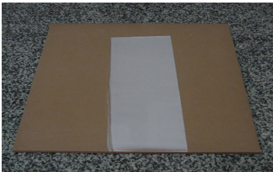
Figura 16 – Aplicação do esmalte sobre o suporte
