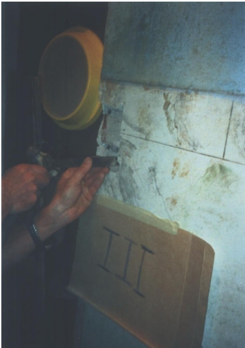
Figura 11: Retirada da amostra de Escariola na residência de Ieda A. Ungericht. LUZERNA/SC.
