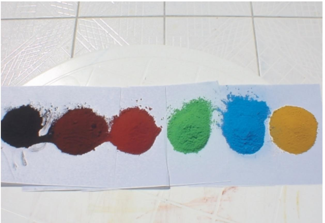
Figura 20: seis cores de pigmento "Pó Xadrez" usados na pesquisa.
