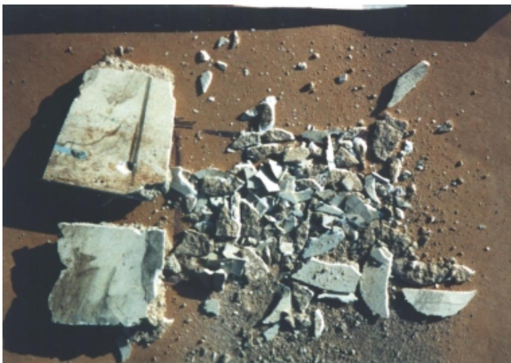
Figura 15: Amostra da Escariola de 15x15cm e 3,0mm espessura, retirada na residência de Ieda A. Ungericht. LUZERNA/SC
