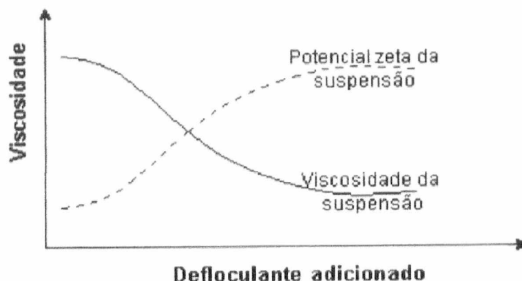
Figura 1- Efeito da adição de defloculante sobre a viscosidade em uma suspensão de argila. [Nogueira, 1997].
