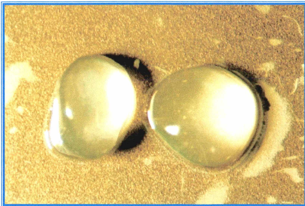
FIGURA 8 - FOTOGRAFIA DE CÁPSULAS DE QUITOSANA/ALGINATO OBTIDAS POR GOTEJAMENTO DE SOLUÇÃO AQUOSA A 1% DE ALGINATO DE SÓDIO SOBRE SOLUÇÃO A 1% DE QUITOSANA EM HCL 0,01M.
