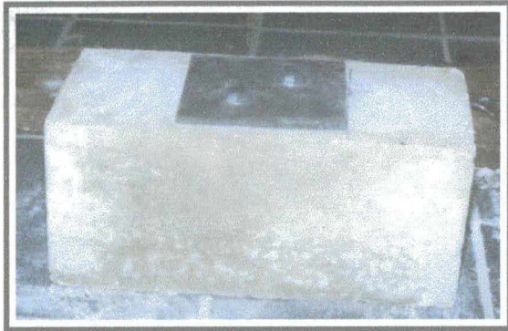
Figura 5.7 – Mecanismo de incremento de ancoragem por chapa de aço e parafuso
