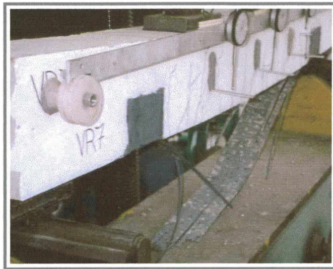
Figura 6.21 – Detalhe da ruptura da manta de fibra de carbono na viga VR7
