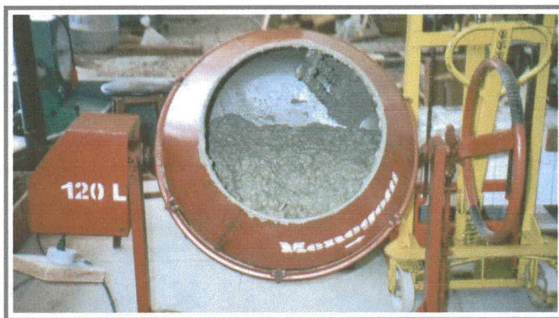
Figura 5.13 - Aspecto do concreto no interior da betoneira
