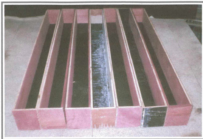
Figura 5.10 – Fôrmas de madeira utilizadas
