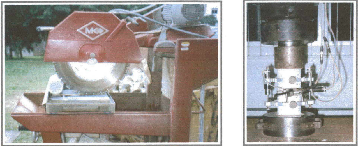
Figura 5.28 – Detalhes: preparação (esquerda) e ensaio (direita) dos corpos de prova de concreto
