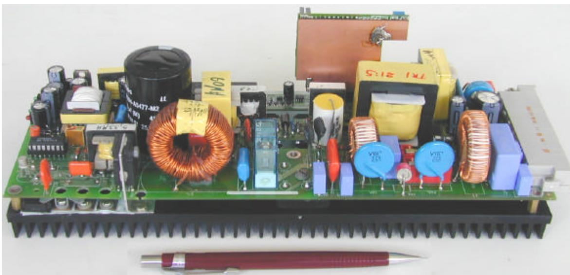
Fig. 11-8 - *Layout* do terceiro protótipo da UR2: Vista lateral.
