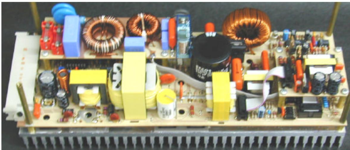
Fig. 11-4 – *Layout* do primeiro protótipo da UR2: Vista lateral.
