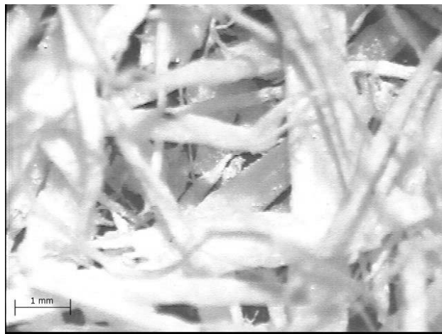
Figura 3.4- Fotografia das Fibras de mandioca, aumento de 25X.
