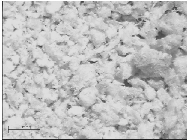
Figura 3.1- Fotografia do bagaço de mandioca seco, aumento de 34X.
