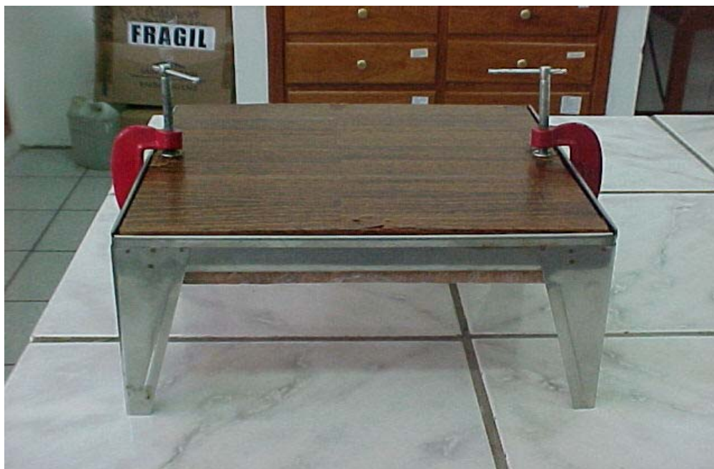
Figura 8. Prensa utilizada na elaboração do tablete de pequi (Fonte: acervo do autor).
