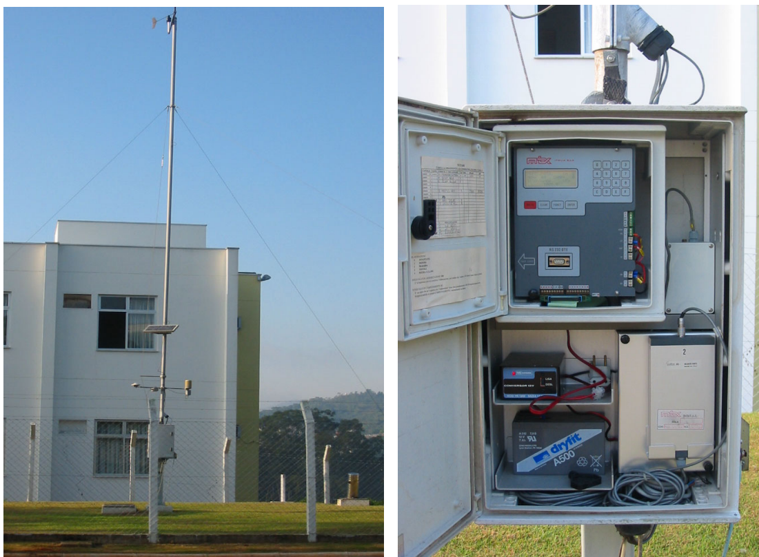
FIGURA 4.2 – ESTAÇÃO METEOROLÓGICA AUTOMÁTICA ITALIANA MTX, INSTALADA EM MARÇO DE 1993 NO CAMPUS - I DA FURB.
