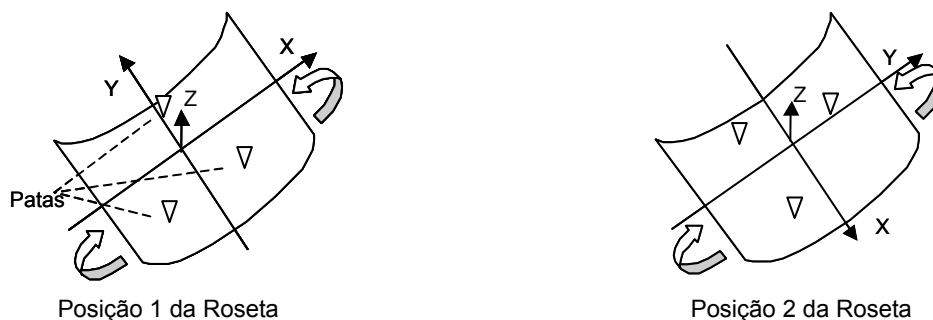
Figura 6.12 – Disposições da Roseta Óptica na base do corpo de prova “U”
