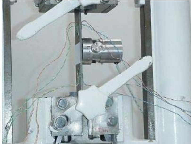
Figura 6.14 – Roseta Óptica montada no corpo de prova “I”, para ensaio em máquina universal de ensaios /Willemann, 2002/
