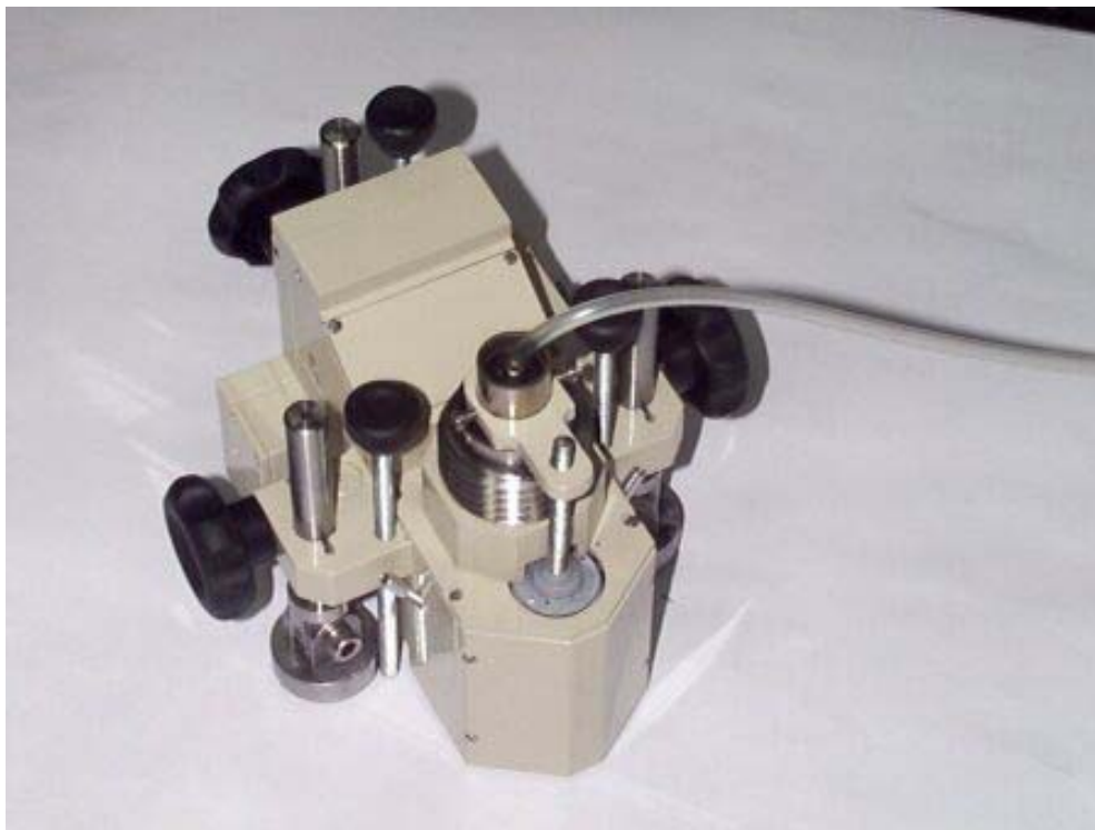
Figura 3.5 – Sistema MTRES – Medidor de tensões residuais /Borges, 2000/
