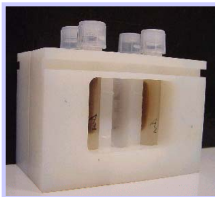
Figura 17: Estante magnética com quatro tubos de 6mL contendo, sobrenadantes de amostras de lodo da ETE da CASAN – Sistema Insular, Florianópolis, usados para processamento da separação imunomagnética.
