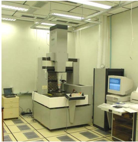
Figura 4.4 - Máquina de medir por coordenadas de referência do Laboratório de Medição por Coordenadas da Fundação CERTI
