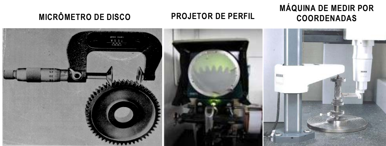
Figura 3.7 - Principais sistemas de medição flexíveis utilizados na medição de engrenagens
