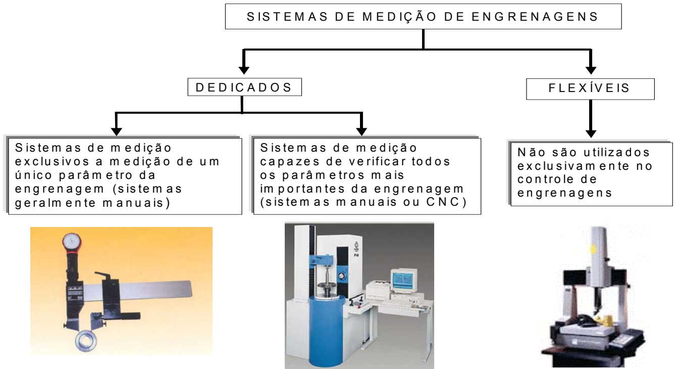
Figura 3.4 - Opções para a medição de forma analítica de engrenagens
