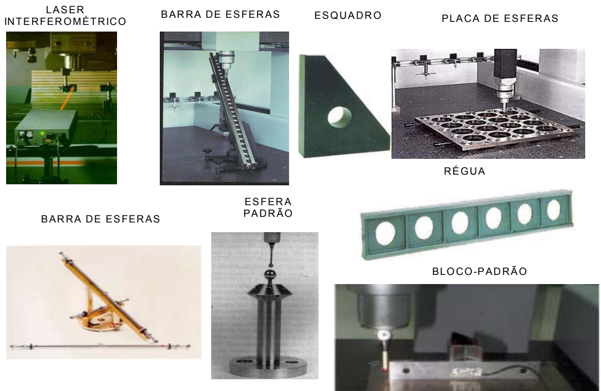
Figura 4.6 - Principais padrões utilizados na calibração de CMMs [53][4].
