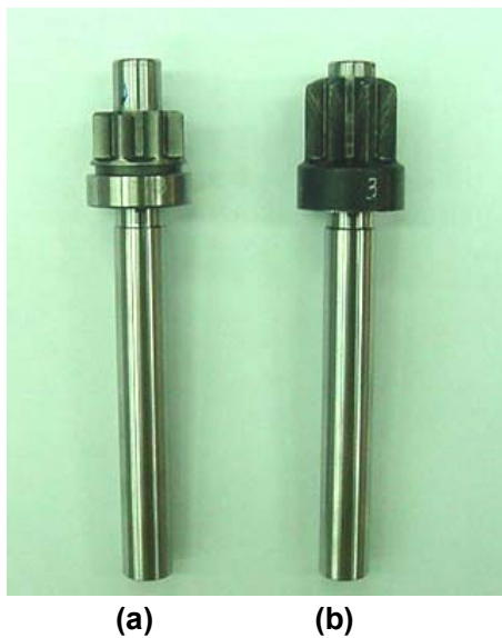
Figura 6.7 - Engrenagens padrão utilizadas: (a) engrenagem acabada; (b) engrenagem bruta.
