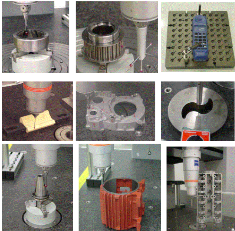
Figura 4.7 - Medição de peças com geometrias complexas em CMMs.
