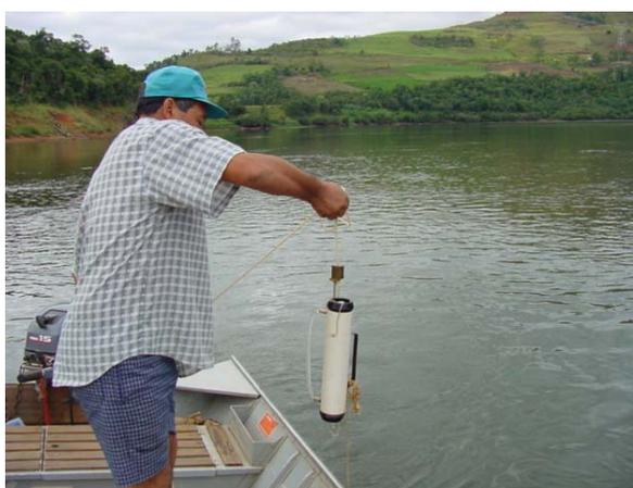
**Figura A10.** Coleta de água de fundo com garrafa Van Dorh.
