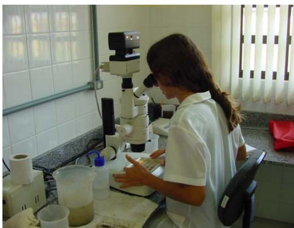
**Figura A12.** Triagem das amostras utilizando-se microscópio estereoscópico.
