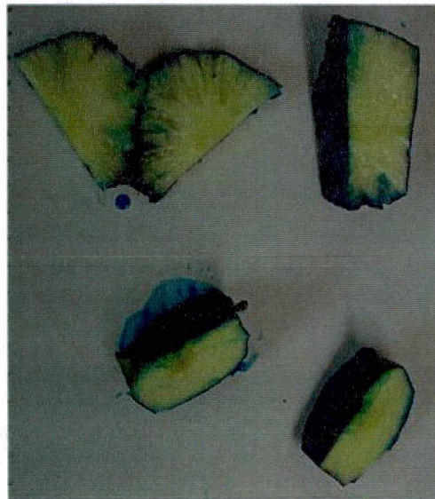
Figura 4.12 - Ensaio EF12, difusão da solução de sacarose a 39% e azul de metileno à pressão atmosférica, durante 60 minutos.
