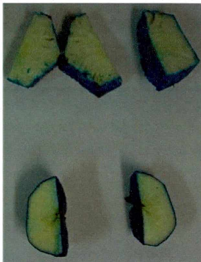
Figura 4.10 - Ensaio EF10, difusão da solução de sacarose a 10% e azul de metileno à pressão atmosférica, durante 60 minutos.
