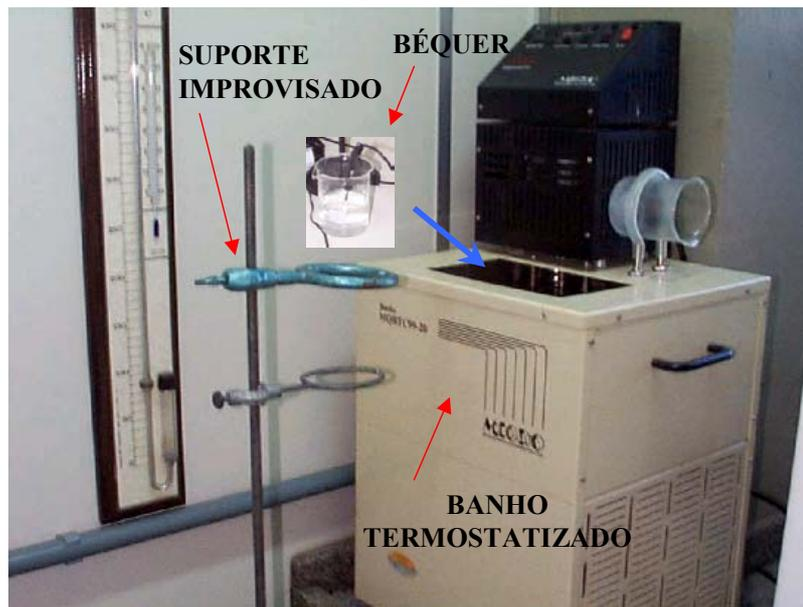
Figura 3.20 Banho termostatizado e suporte para fixação do béquer
