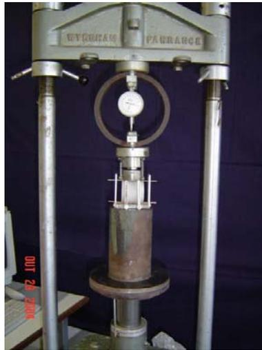
**Figura 3.10** Máquina de ensaios mecânicos.
