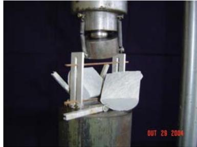
**Figura 3.12** Ruptura de corpo-de-prova à tração por compressão diametral.
