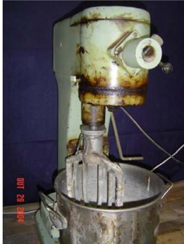
**Figura 3.3** Misturador mecânico para homogeneização das misturas.
