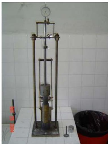
**Figura 3.4** Equipamento de compactação em miniatura.
