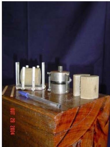
**Figura 3.13** Parte do sistema projetado e de corpos-de-prova antes e depois da ruptura.
