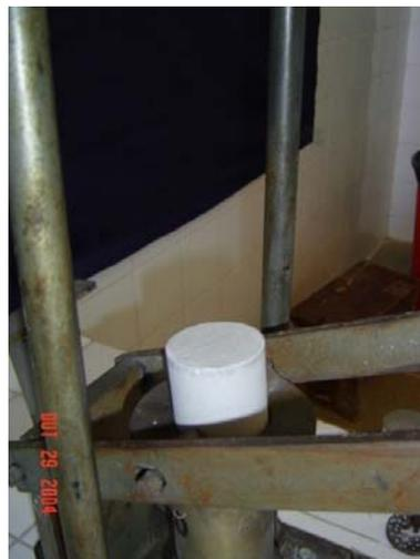
**Figura 3.6** Detalhe da extração do corpo-de-prova do molde.
