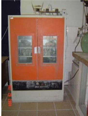
**Figura 3.8** Estufa com controle de temperatura utilizada na cura dos corpos-de-prova.
