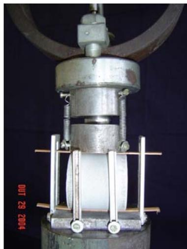
**Figura 3.11** Sistema de posicionamento e centralização de corpos-de-prova.
