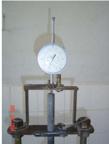
**Figura 3.5** Equipamento para controle individual da altura dos corpos-de-prova.
