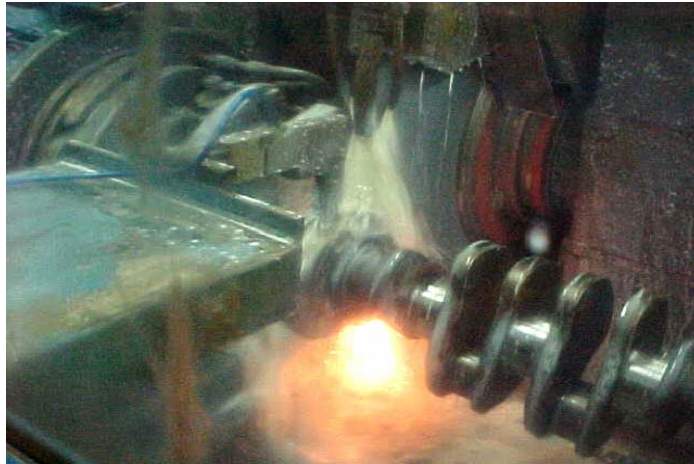
Figura 4.6 Operação de retificar moentes
