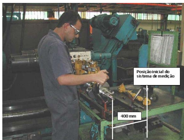
Figura 5.3 Posição de medição do produto, vista lateral. Observar a distância entre o padrão de referência (posição inicial do sistema de medição) e a posição em que o sistema de medição é efetivamente utilizado
