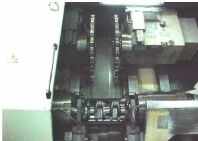
Figura 4.2 Operação de torneiar munhões
