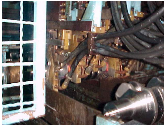
Figura 4.4 Operação de temperar por indução
