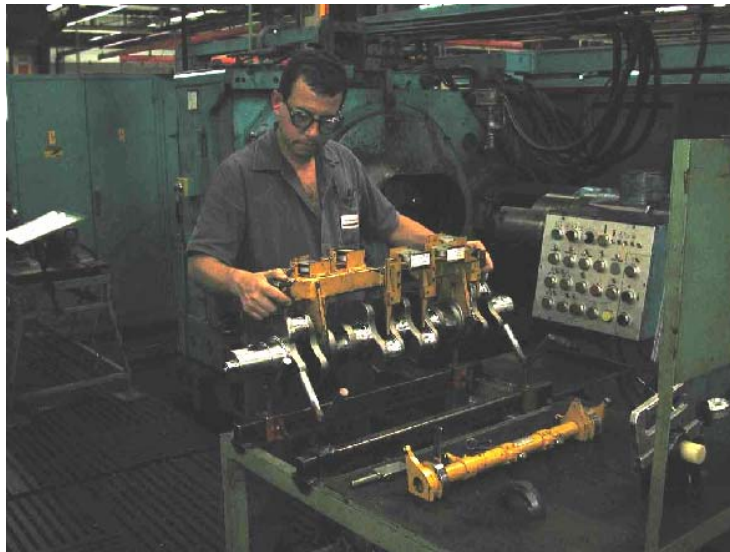
Figura 5.1 Sistema de medição de comprimentos de virabrequim.
