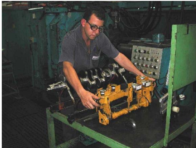
Figura 5.2 Posição inicial da movimentação do Sistema de Medição de Comprimentos, operador deverá erguer o dispositivo e posiciona-lo sobre a peça.
