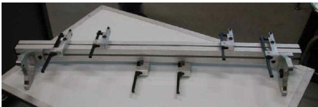
Figura 5.9 Sistemas de Medição de Comprimento confeccionado em alumínio peso 4100 gramas.
