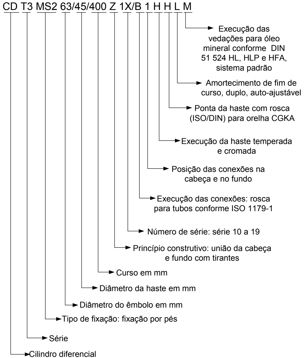
Diagrama 4 – Especificações técnicas do cilindro hidráulico diferencial
