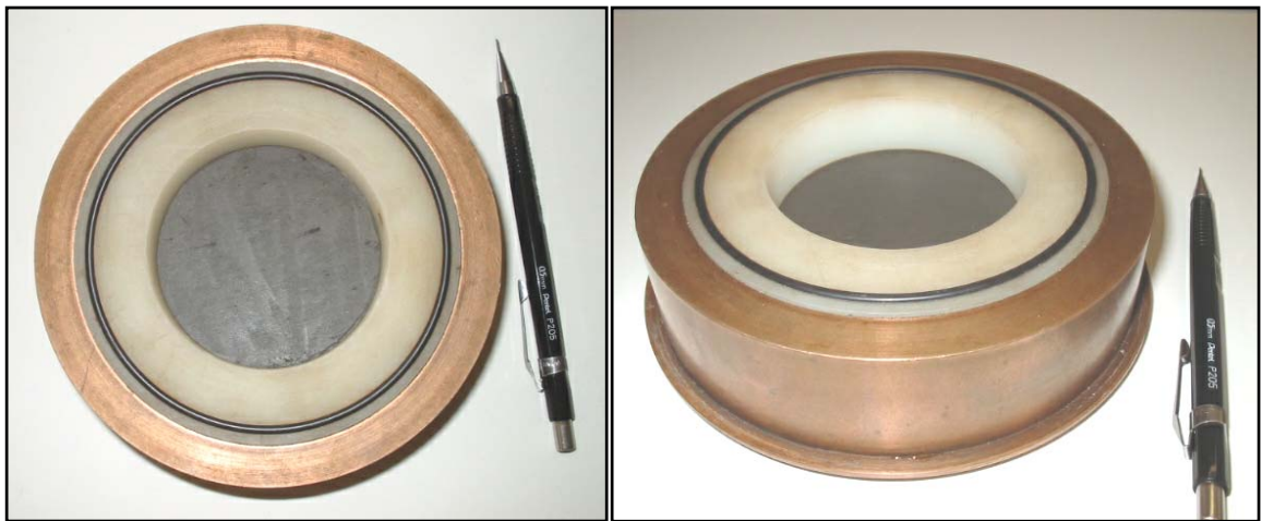
Figura 4.4 – Vista superior e frontal da célula de adensamento juntamente com o corpo de prova
