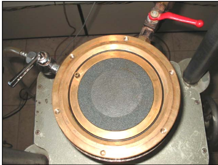
Figura 4.5 – Pedra porosa incrustada na superfície da base
