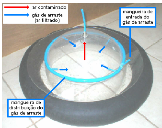
Figura 10 – Esquema da câmara de fluxo para amostragem em superfícies líquidas.
