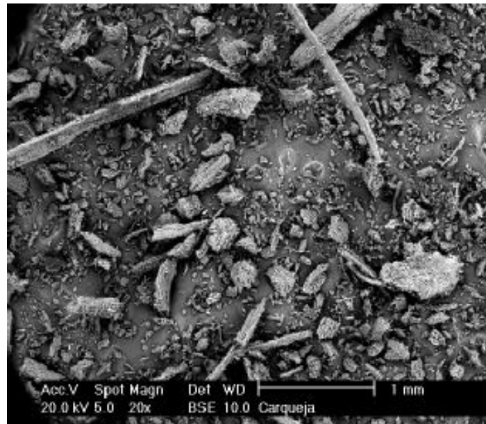
Figura 10: Micrografia de Partículas de carqueja com o aumento de 20 vezes
