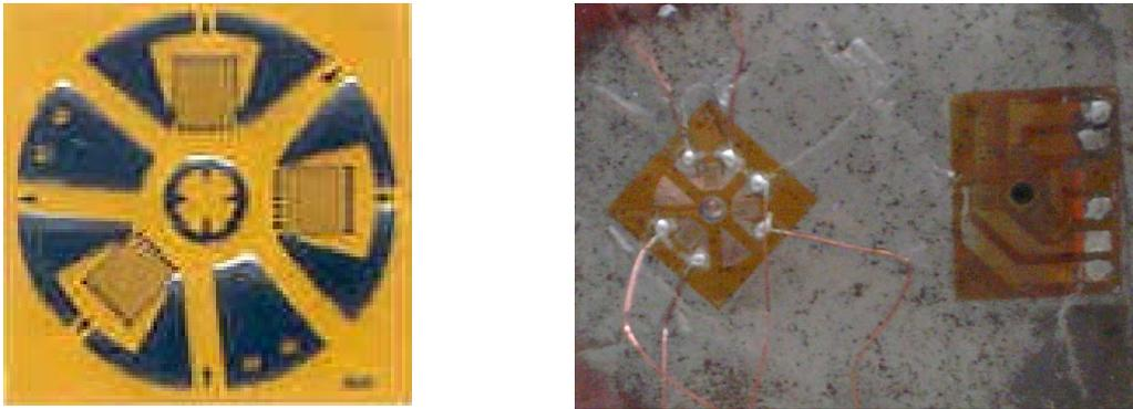
Figura 2.1 (a) Roseta extensométrica (b) Duas diferentes configurações de rosetas extensométricas coladas na superfície de medição
