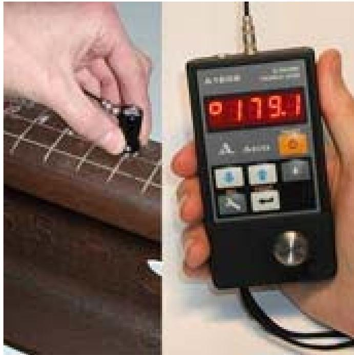
Figura 5.10 Sistema de ultra-som para medição de espessura de paredes [19].
