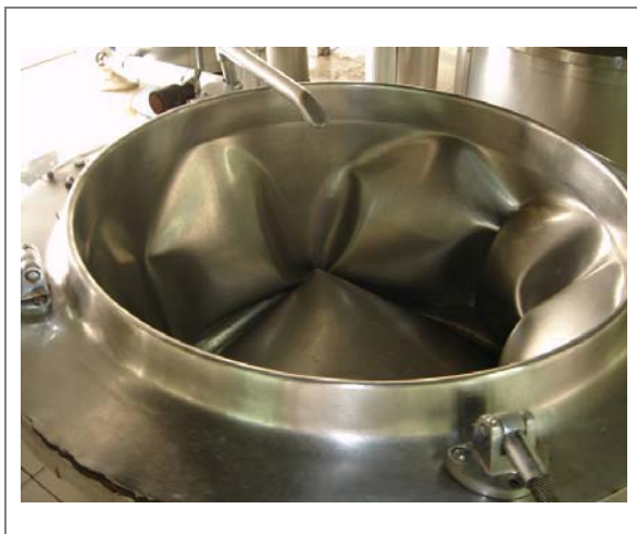
FIGURA 12 – Registro fotográfico de caldeirão danificado do Serviço de Nutrição e Dietética do Hospital Universitário da Universidade Federal de Santa Catarina, Florianópolis, 2005.
