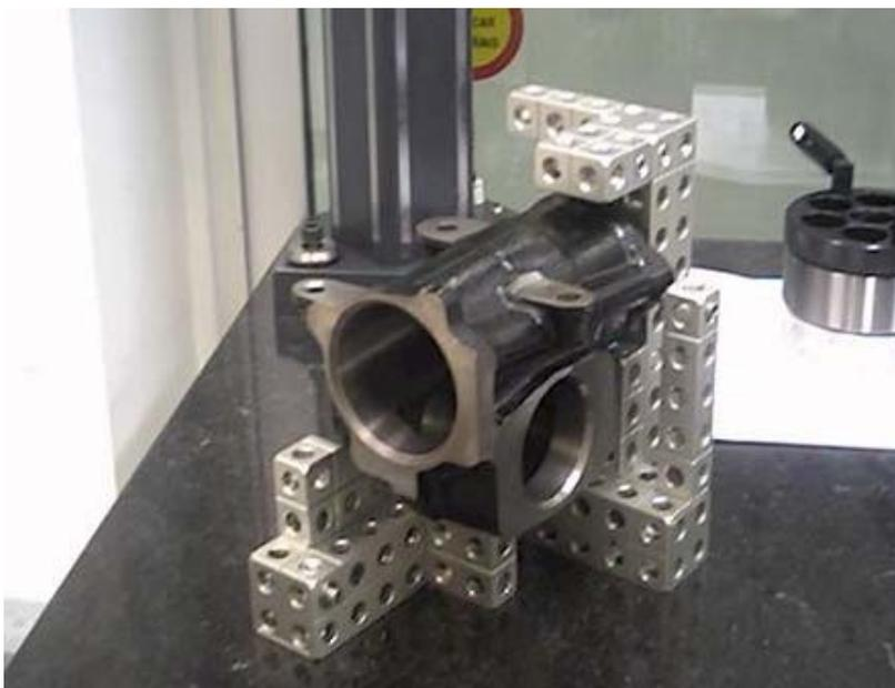
Figura 54 – A carcaça de medição montada no sistema de fixação modular Witte.
