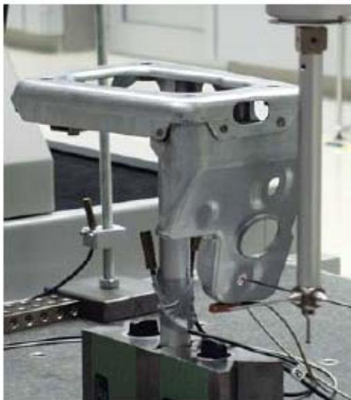
Figura 29 – Calibração de uma peça para ser usada como artefato de referencia para monitoramento de MMC no chão de fábrica <sup>[63]</sup>.
