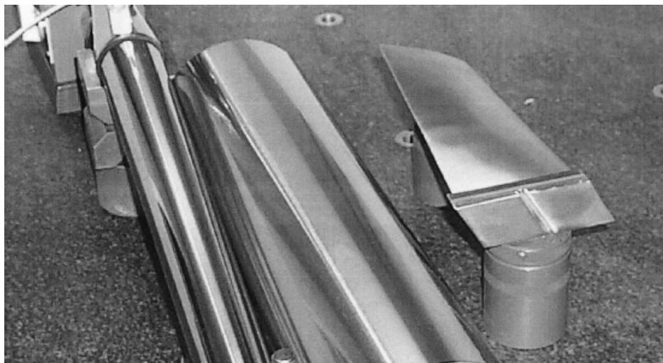
Figura 34 – Calibração de uma pá de turbina através do uso de objetos padrão modulares. Adaptado de [83].
