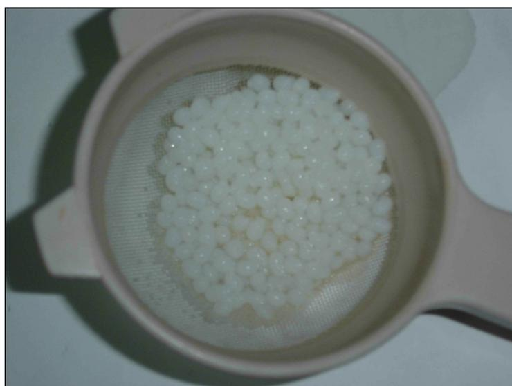
**Figura 16:** Esferas em processo de lavagem com água destilada.
